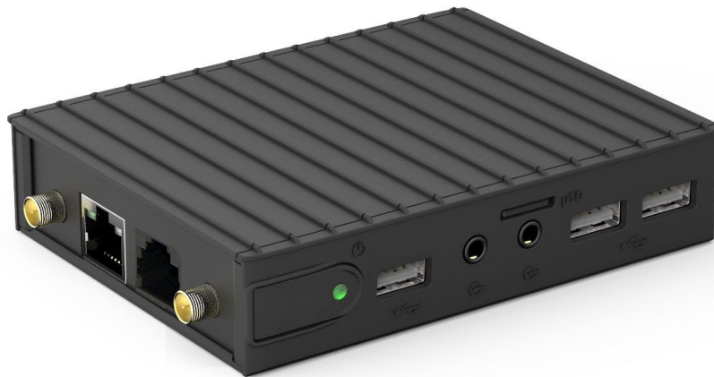
BIXCS-1300 in Gehäuse 1, BxHxT= 108 x 83 x 24 mm
